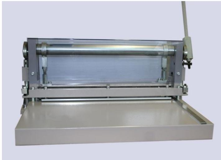
Die professionelle Plattenschere PPC ist zum Schneiden von Aluminium-, Zink- und Stahlblech, und von Plastikfolien geeignet, wie sie als Vorlagen für Brailledruck verwendet werden. Diese Materialien sind problemlos bis zu einer Stärke von 1 - 2 mm zu bearbeiten.
